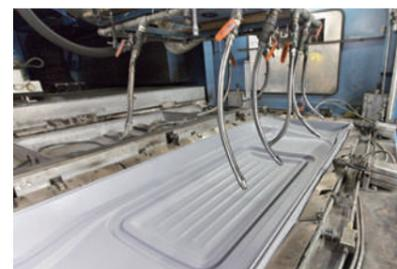
プラスチックシート素材を加熱・軟化させて製品形状をつくる真空成形技術により、お客様のニーズに応じた大型、軽量、高強度なプラスチック製品を生産。比較的安価に金型の作成ができ、短期間で小ロットな製造オーダーにも対応が可能です。
