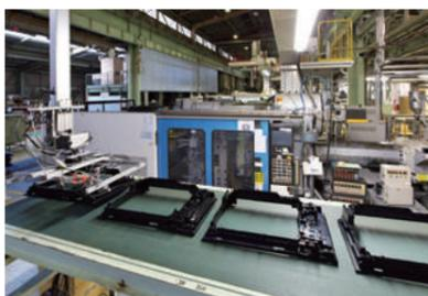
精密かつ複雑な形の製品づくりに最適な、金型内にプラスチック素材を注入して形状をつくる射出成形技術。ガスインジェクションを主とした中空・軽量化技術、H&C(Heat&Cool)を主とした無塗装・高外観技術などにより、多分野へ先進のプラスチック製品を提供しています。
